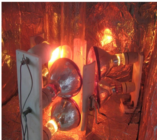
شکل (۲): نمایی از محفظه خشک کن و لامپهای مادون قرمز دستگاه
