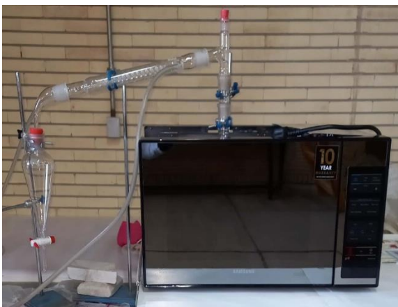
شکل ۲- سیستم تقطیر با آب به کمک مایکروویو
