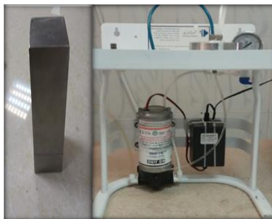
شکل ۱: سیستم تراوش و فیلم کش
