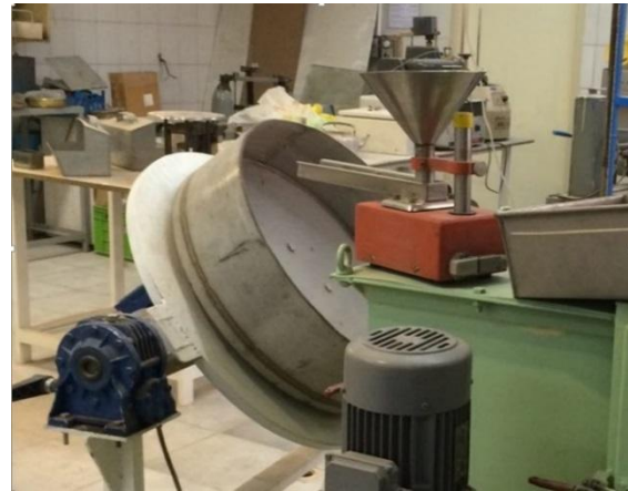
شکل (۳) نمایی از تجهیزات آگلومراسیون پیوسته (خوراک‌دهنده و دستگاه آگلومراسیون)
