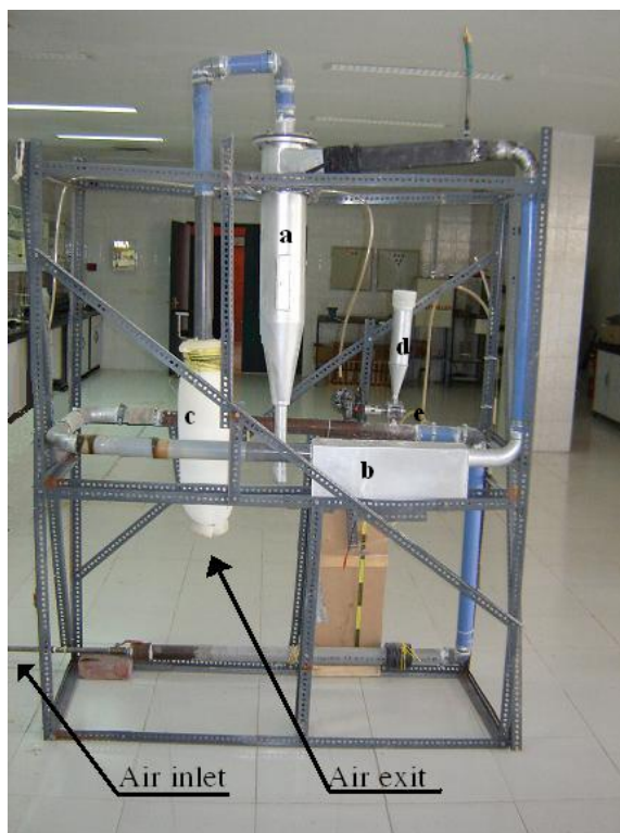
شکل (۷): نمای کلی پایلوت a سیکلون، b مخزن ته نشینی، c فیلتر، d هاپر، e شیر گردان
