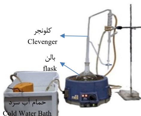
شکل ۳. چیدمان مربوط به استخراج از گیاه پونه به روش تقطیر با آب
