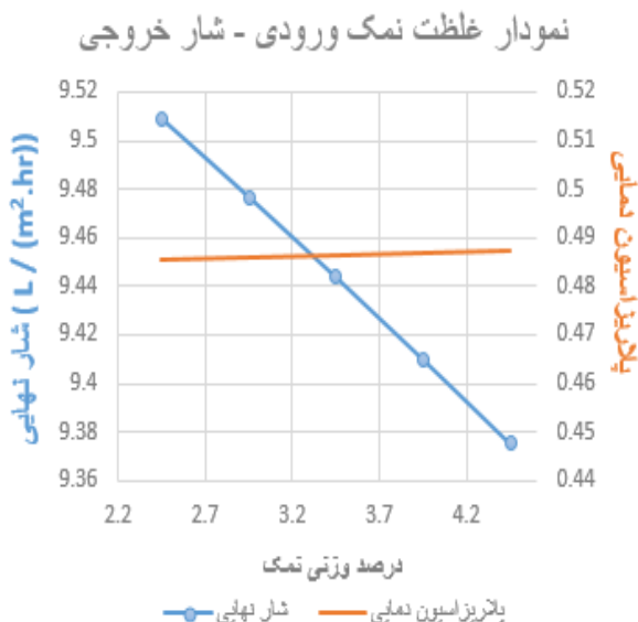
شکل ۱۶. بررسی اثر غلظت نمک خوراک ورودی بر عملکرد فرآیند تقطیر غشایی تماس مستقیم Figure 16. Investigating the effect of salt concentration of the incoming feed on the performance of the direct contact membrane distillation process
