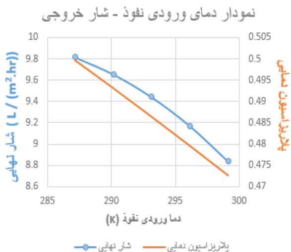
شکل ۱۲. بررسی اثر دمای ورودی نفوذ بر عملکرد فرآیند تقطیر غشایی تماس مستقیم
