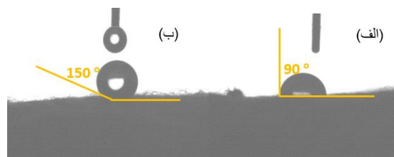
شکل ۷- زاویه تماس با آب مقطر نسبت به افق برای الیاف-کربنی، (ب) نانوکامپوزیت الیاف کربنی / ZIF-8: تولید شده در دمای 25^{\circ}C ؛ زمان ۲ ساعت غوطه وری.
