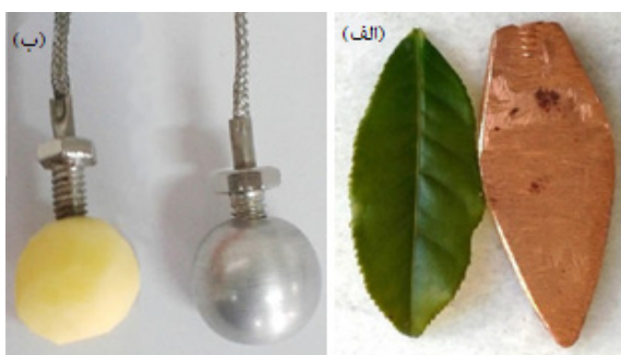
شکل (۳) (الف) نمونه تیغه مسی (ب) نمونه کروی آلومینیومی مشابه نمونه های اصلی برای محاسبه h
