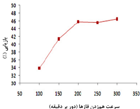
شکل ۴. تغییر درصد بازیابی کبالت با سرعت هم‌زدن فازها.
