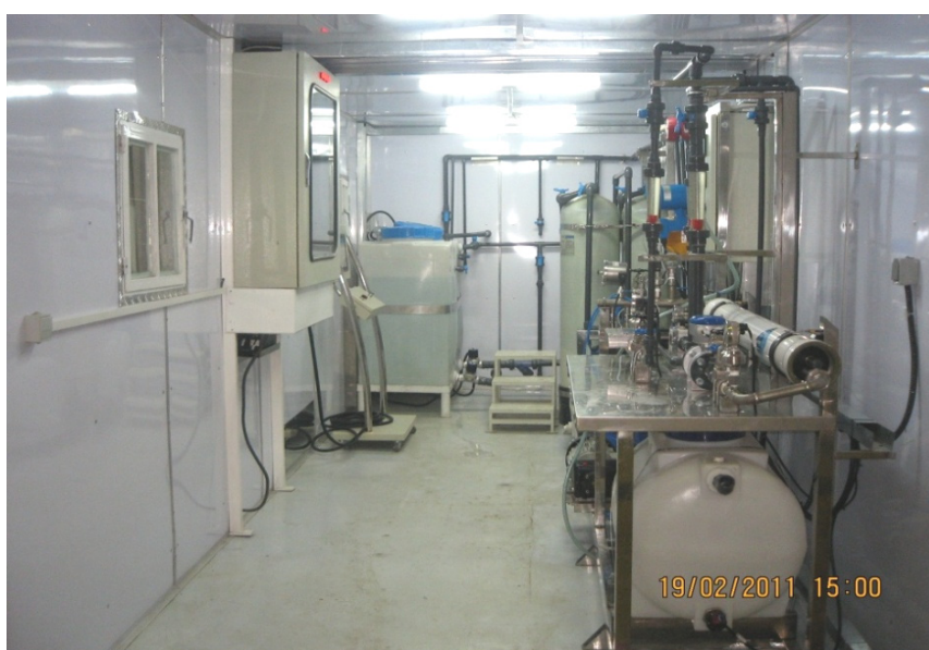
شکل (۳) نمای داخلی پایلوت قابل حمل RO
