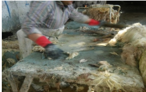
شکل (۲) موبری به روش دستی در چرم‌سازی همدان
